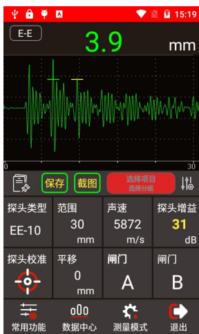
图 2 - 超声测厚 APP 的 A 扫测量界面
